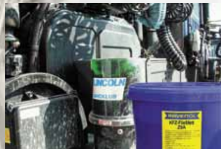
Централизованная система смазки HYUNDAI HD 500 EURO 4
