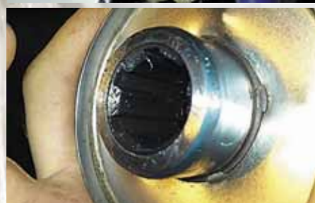
Рабочая поверхность сальника фланца и его шлицы
