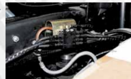
Централизованная система смазки Lincoln на грузовом автомобиле DAF
