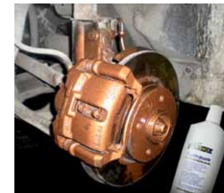
Подвеска Renault Logan после нанесения медной пасты RAVENOL Kupferpaste.
